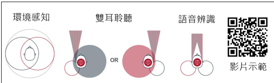
保留空間線索的概念也反映在方向性的分頻處理，GN新一代的訊號處理把方向性依據頻率分成3段：低頻的全向性維持音質飽滿與雙耳音強線索、中頻則採用雙耳自動方向性提高訊噪比，高頻使用的固定方向性則可以維持雙耳間的時間差。使用者覺得環境非常吵時，則可以透過App，調整成超級語音聚焦(Ultra Focus)模式。自動+手動模式，適應不同的環境需求。
